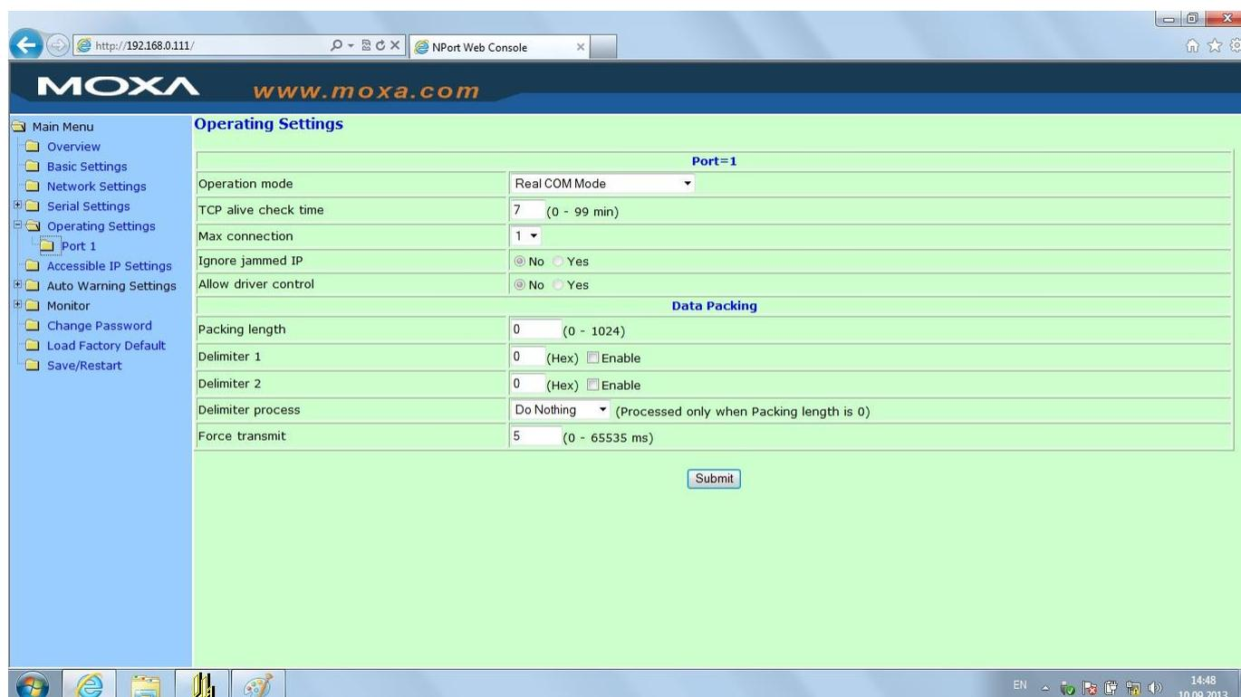
Установить настройки, как указано на рисунке. Принципиально важной является настройка параметра Force transmit. Значение этого параметра =5 ms (в заводских
