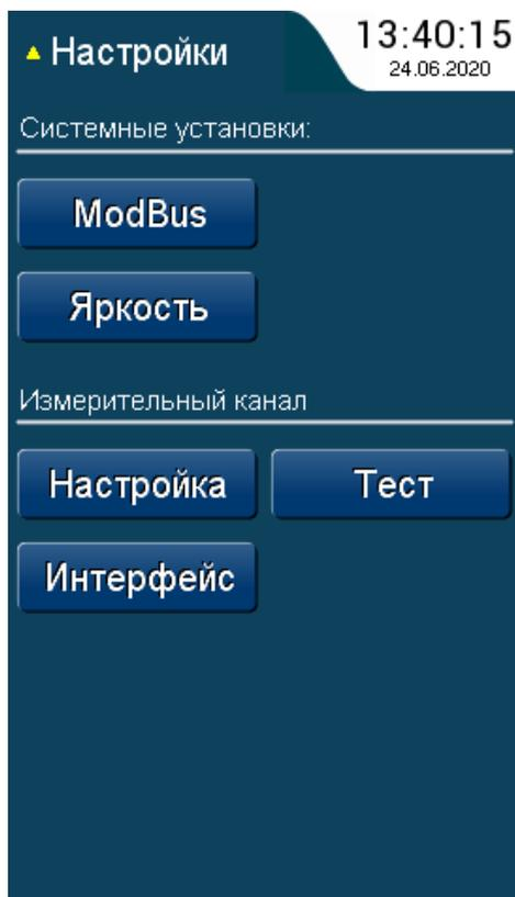
**5.1.5** Сервисный экран содержит кнопки, обеспечивающие переход к экранам настройки прибора: **«ModBus»** – на экран настроек интерфейса ModBus 5.1.6, **«Яркость»** – на экран настройки яркости подсветки экрана 5.1.7, **«Настройка»** – на экран настройки измерительных каналов 5.1.8.
