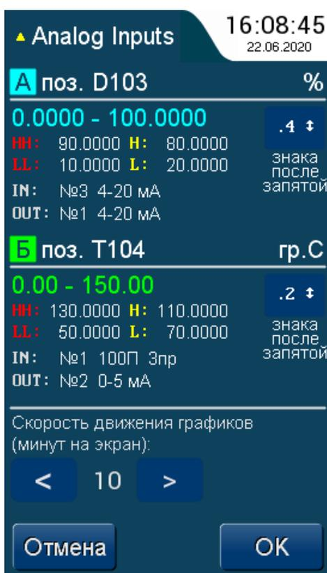
**5.1.8** Экран настроек аналоговых входов. В верхней части содержит информацию по задействованным каналам измерения: технологическая позиция, единица измерения, шкала и уставки входной величины, номера и параметры входов и выходов, а также позволяет задать число знаков после запятой: при нажатии на кнопку циклически 1, 2, 3, 4 знака.
