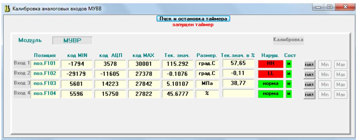
Модули МУВР для входов №1 и №2 имеют заводскую калибровку начала и конца диапазона измерения, охватывающую все предусмотренные типы первичных термопреобразователей и диапазоны измерения температур.
