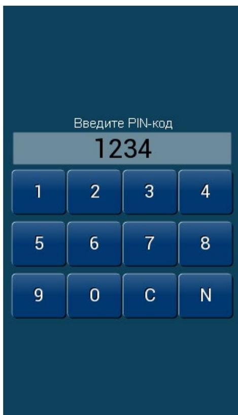
**5.1.10** Окно ввода PIN-кода, возникающее при сохранении критически значимых параметров: настроек ModBus, настроек аналоговых входов, вариантов основного обзорного экрана.
