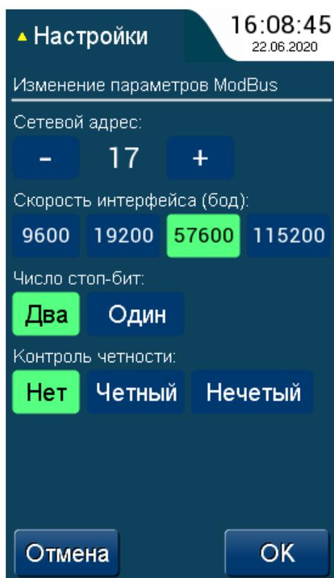
**5.1.6** На данном экране осуществляется просмотр и изменение параметров ModBus интерфейса прибора ПАС-17.
