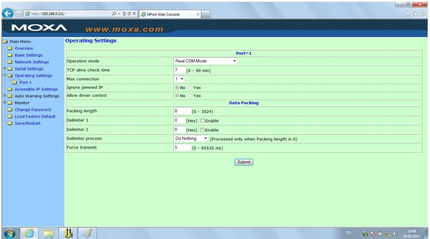
Установить настройки, как указано на рисунке. Принципиально важной является настройка параметра Force transmit. Значение этого параметра =5 ms (в заводских настройках фирмы MOXA этот параметр =0) является длительностью разрыва потока данных, по которому производится переключение интерфейса RS-485 с режима «ПЕРЕДАЧА» на режим «ПРИЕМ» данных.
