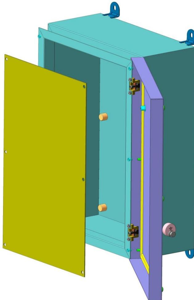
Рисунок 4.2 – Конструкция КВУ-10 с крышкой на петлях
