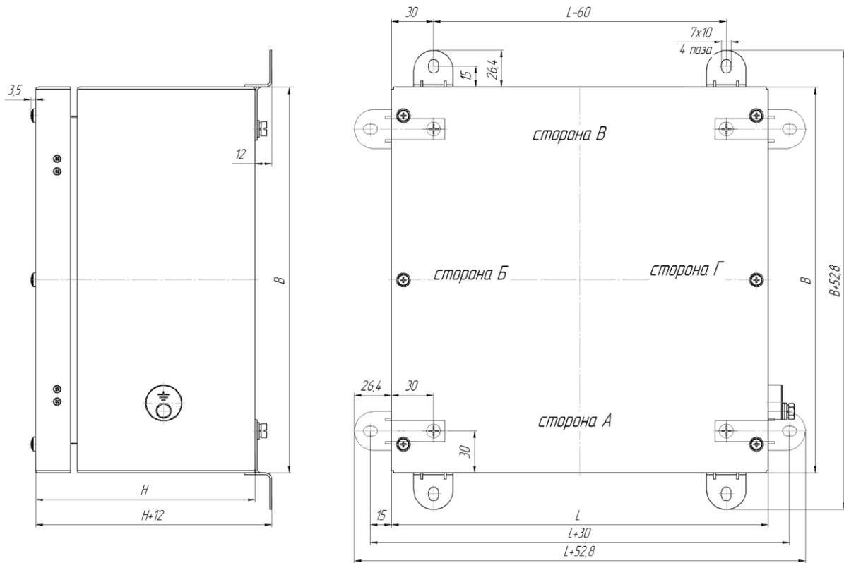
Рисунок А.1 – Габаритно – монтажный чертеж исполнений КВУ-10
